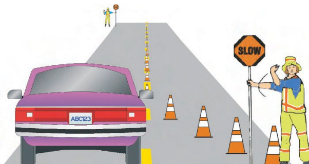
Operación con dos encargados de señalización
